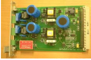
TC 110, fuente alimentación Entrada 85-264 V AC o DC
