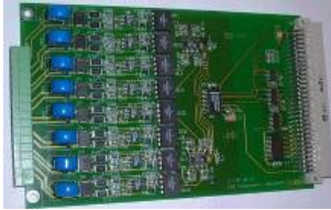
TC130, tarjeta analógica 4-20 mA (8 entradas)
